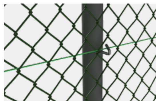
フックボルト/ナットで横線を固定する。
